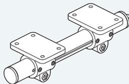
Les unités linéaires tubulaires 93-04 (page AF 06) sont disponibles avec un filetage à droite **et** un filetage à gauche, avec un axe sortant à l'une ou l'autre des extrémités ou aux 2 extrémités. Elles s'utilisent avec deux noix de serrage à embase 93-21 (page AF 17).
